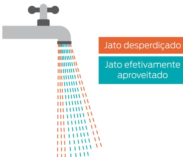
Figura 15 - Exemplo de desperdício de água em componente fabricado em não conformidade com a norma do produto
