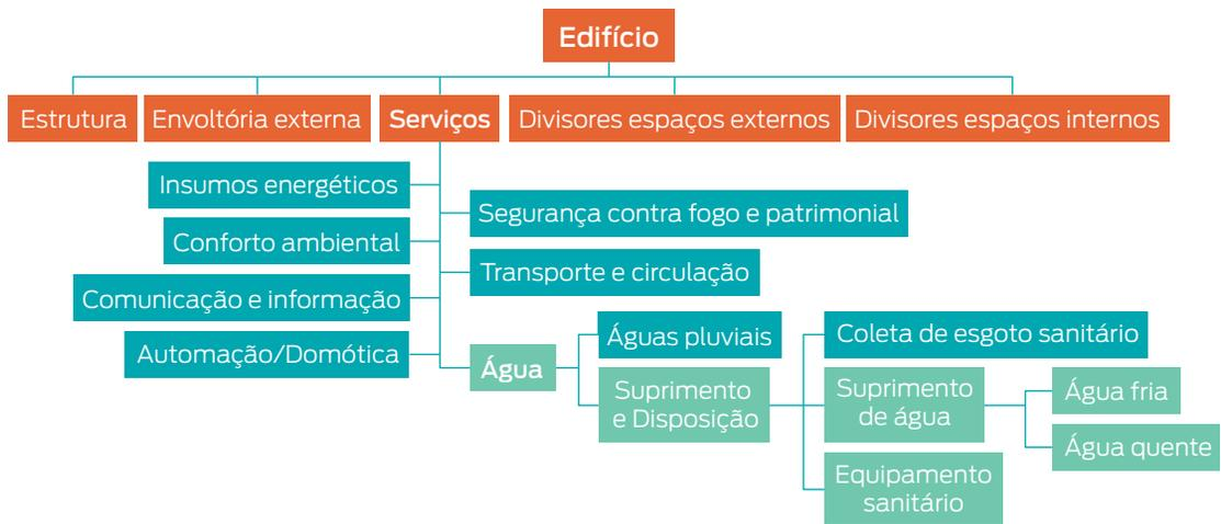
Figura 3 – Subsistemas que compõem o Sistema Edifício. Fonte: Tamaki<sup>11</sup>
