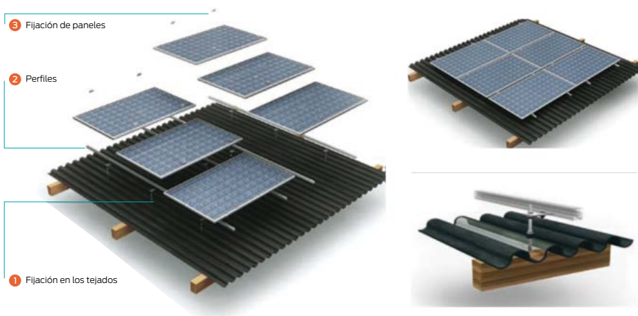
Figura 20 – Fijación en tejados de eternit / Fuente: (Donauer Solartechnik Vertriebs GmbH, 2009)
