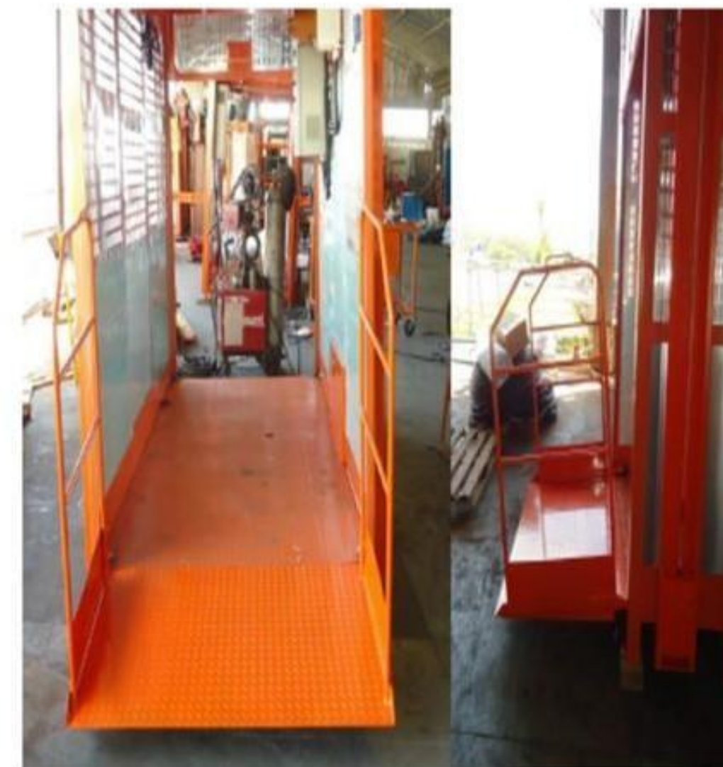
Rampa de Acesso ABAIXADA
