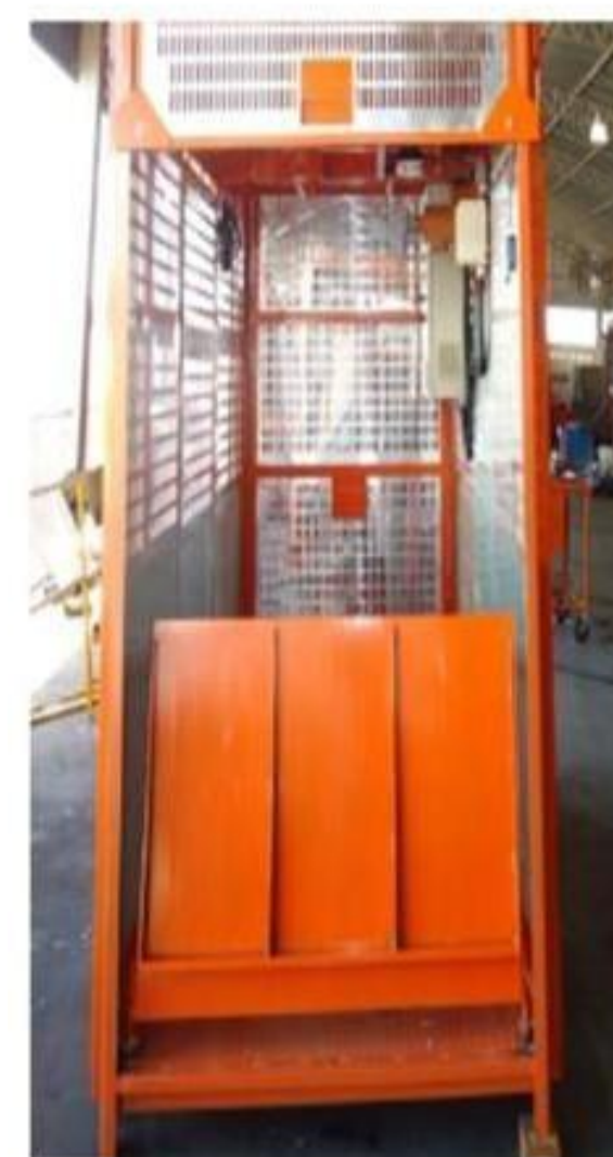
Rampa de Acesso LEVANTADA
