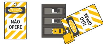
q) Dispositivo de bloqueio por trabalhador com cadeado individual
