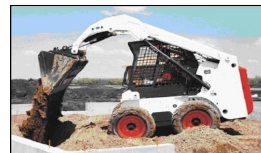
Mini carregadeira – Capacidade nominal de carga 2692 kg. Capacidade da caçamba coroada 400L Potência do motor de 49 HP.
