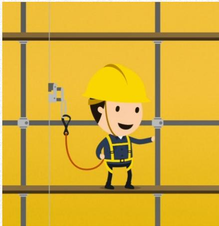
**Cinto de segurança tipo paraquedista, com dispositivo para conexão de ancoragem;**
