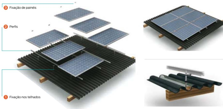
Figura 20 – Fixação em telhados de eternit / Fonte: (Donauer Solartechnik Vertriebs GmbH, 2009)
